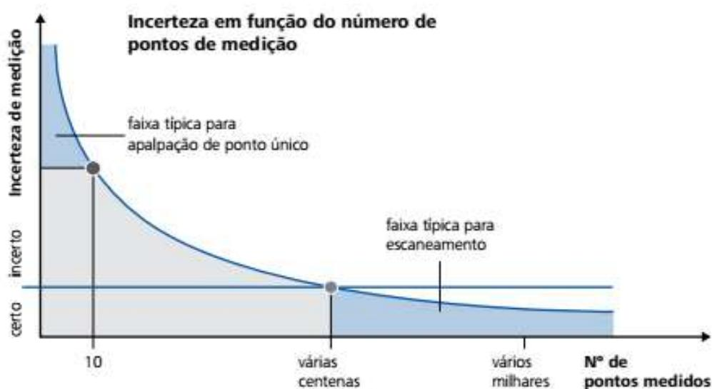
FIGURA 2.11 – Incerteza de medição devido ao número de pontos de medição.
