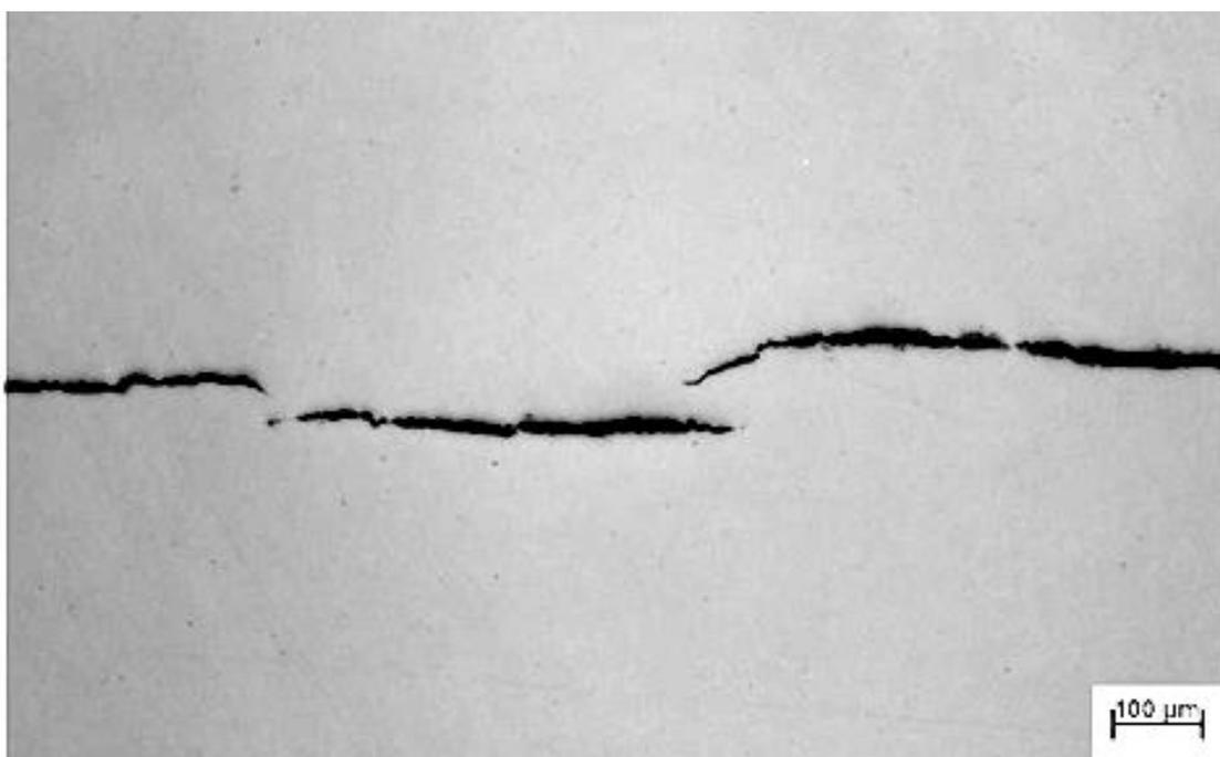
Figura 5.37 - Trinca HIC detectada na seção A do corpo de prova 2, do aço AMn, com ampliação de 100 vezes e sem ataque químico.
