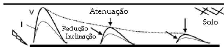
Figura 2.3 – Atenuação e distorção das ondas de tensão e de corrente ao longo do eletrodo. Adaptado de (VISACRO, 2007)
