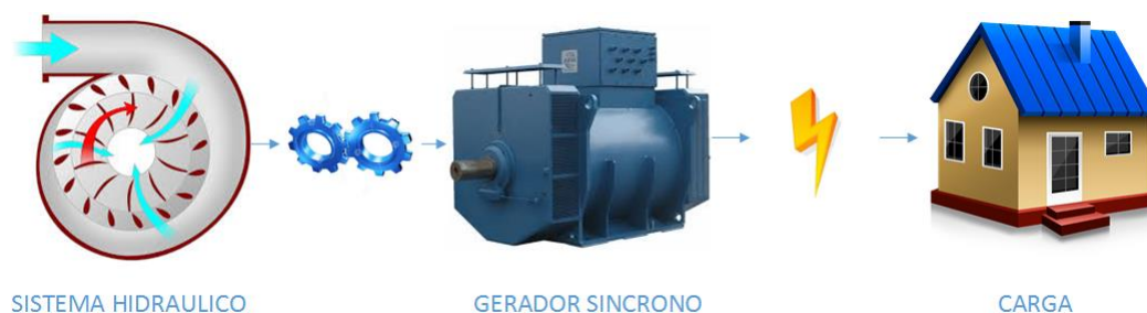
Figura 4.2 – Subsistemas do grupo gerador.
