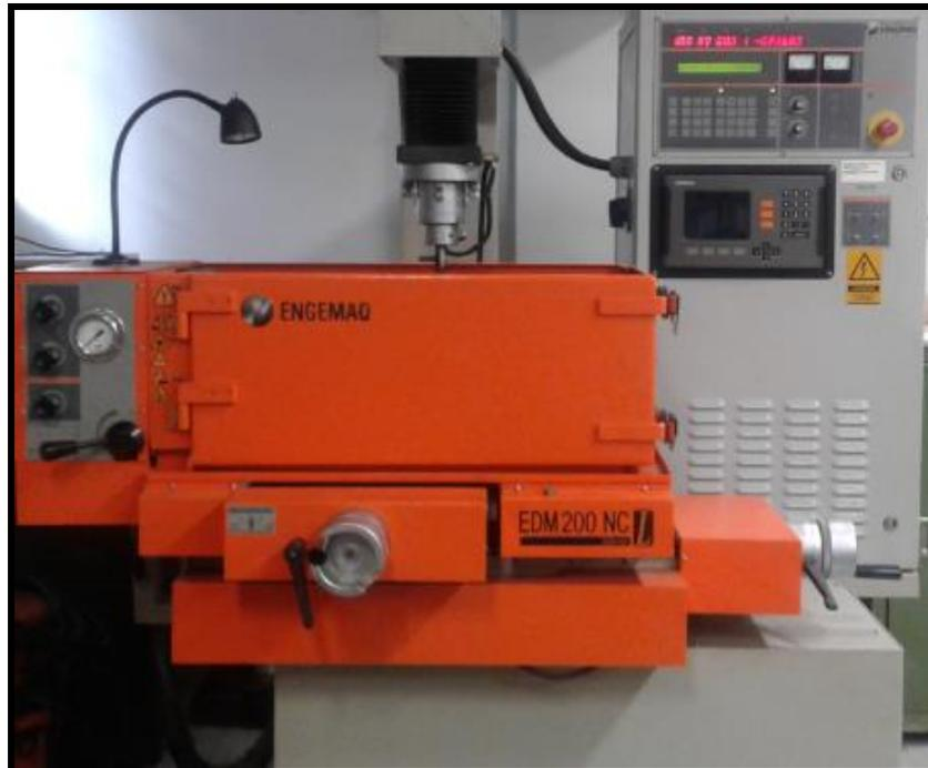
Figura 3.5: Máquina de eletroerosão Engemaq
