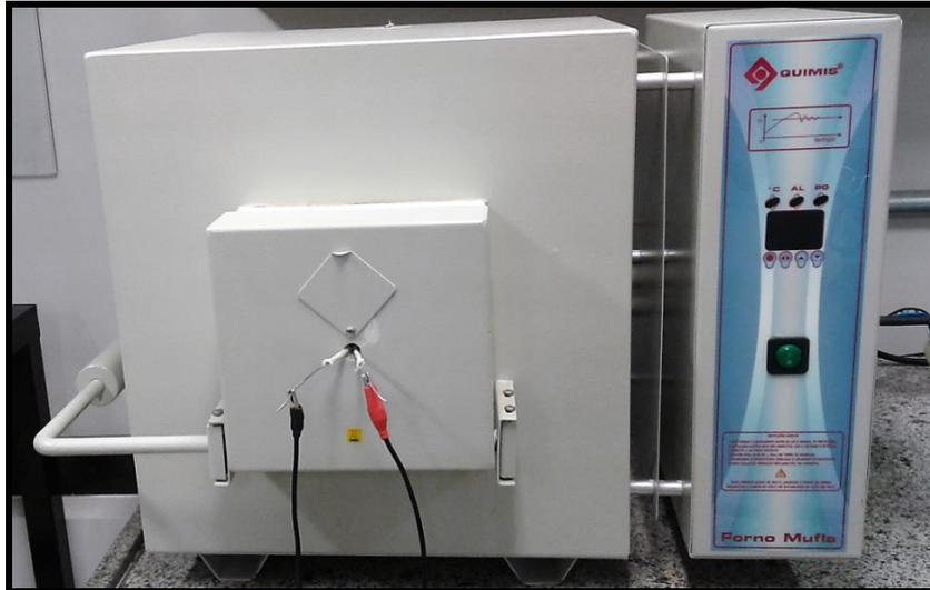
Figura 3.7: Forno para calibração do termopar ferramenta/peça
