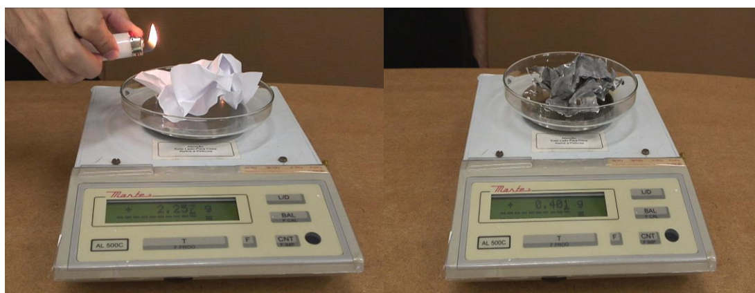
Figura 5. Variação da massa antes e após a combustão do papel. Fonte www.pontociencia.org.br
