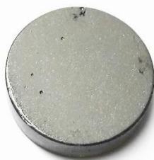
Figura 45 – Amostra preparada para ensaio por microsonda eletrônica
