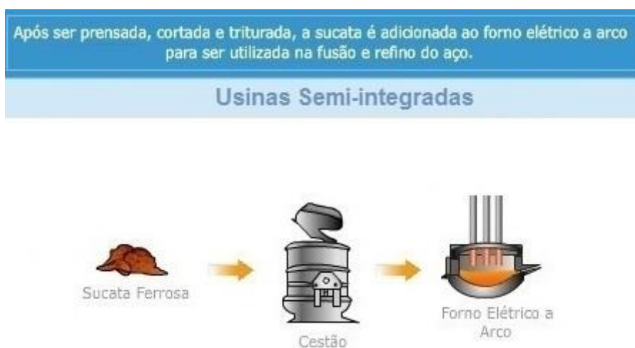
Figura 3 – Refino do aço em uma usina semi-integrada
