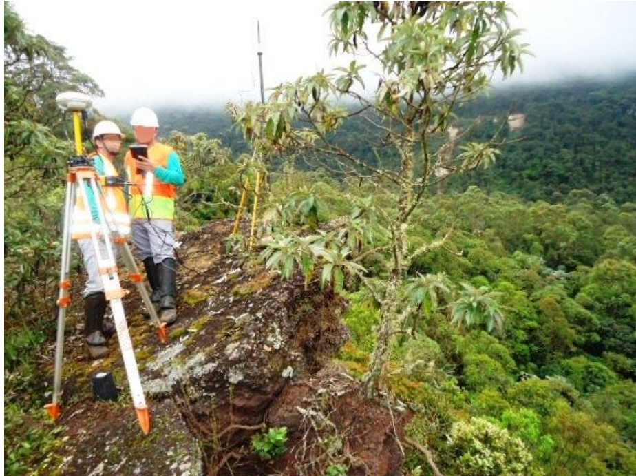
Figura 5 – Instalação da Estação Base
