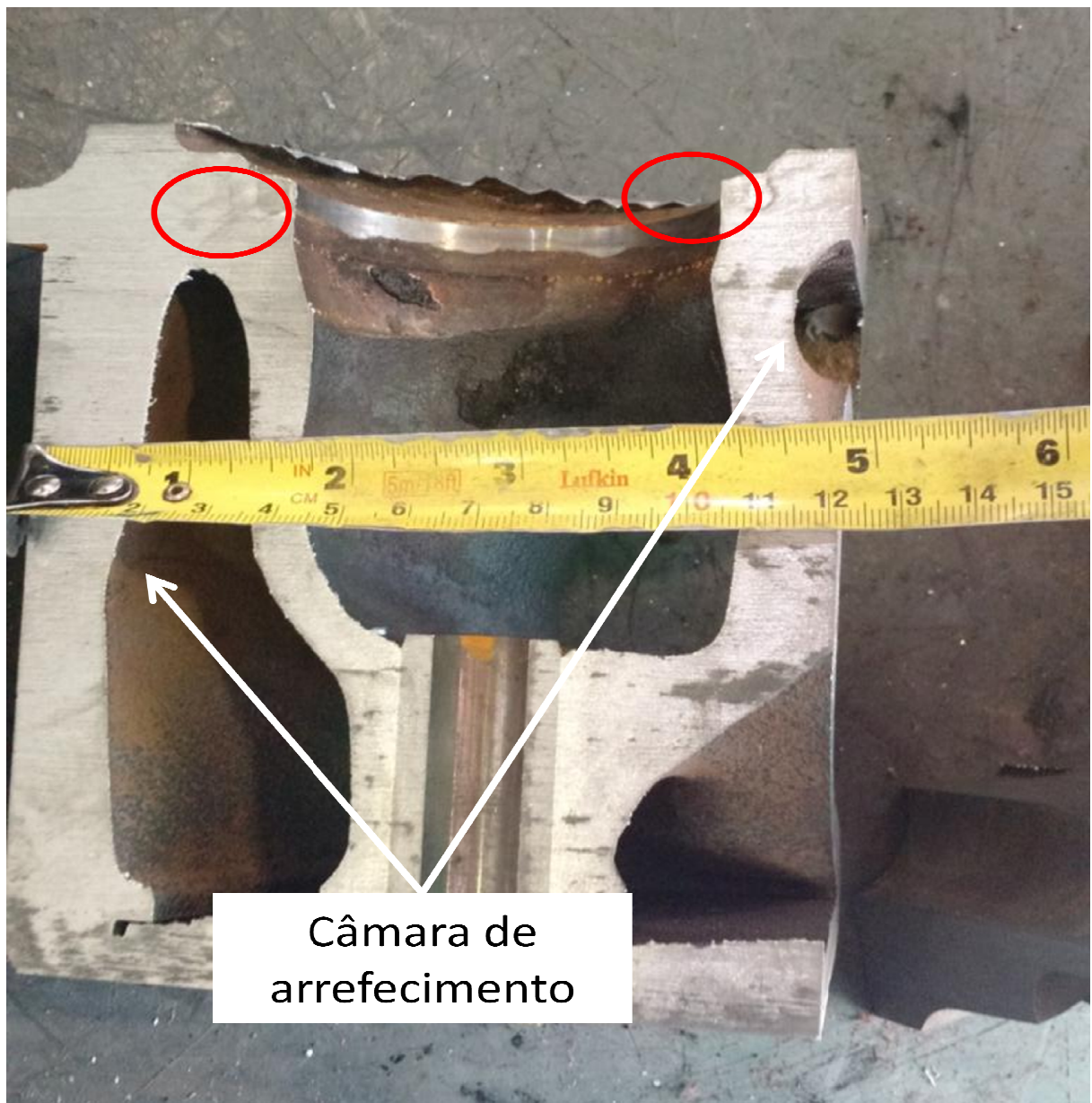
Figura 11 - Detalhe da região da sede da válvula seccionada ao meio.
