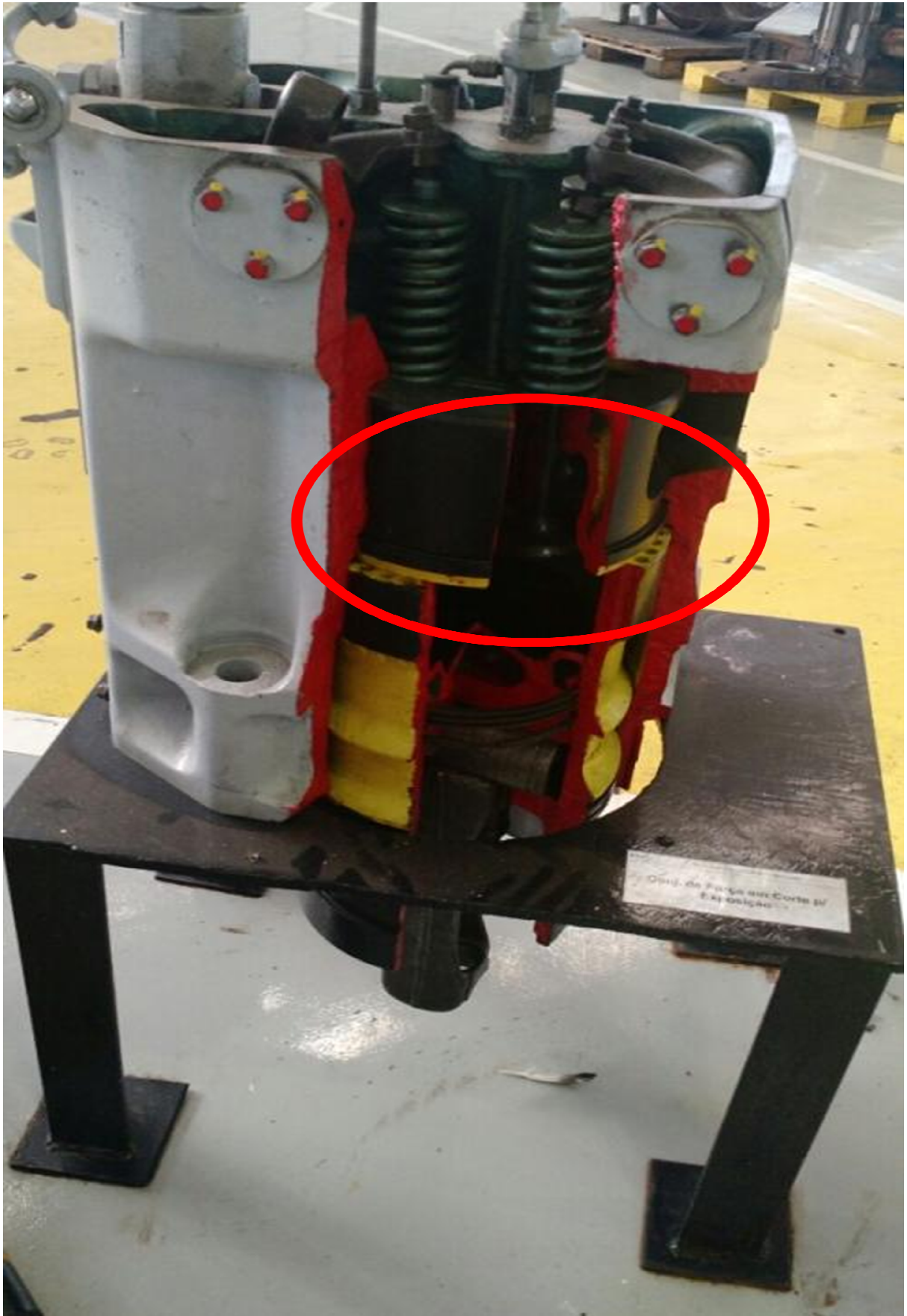
Figura 1 - Vista em corte de um conjunto de força 7 FDL
