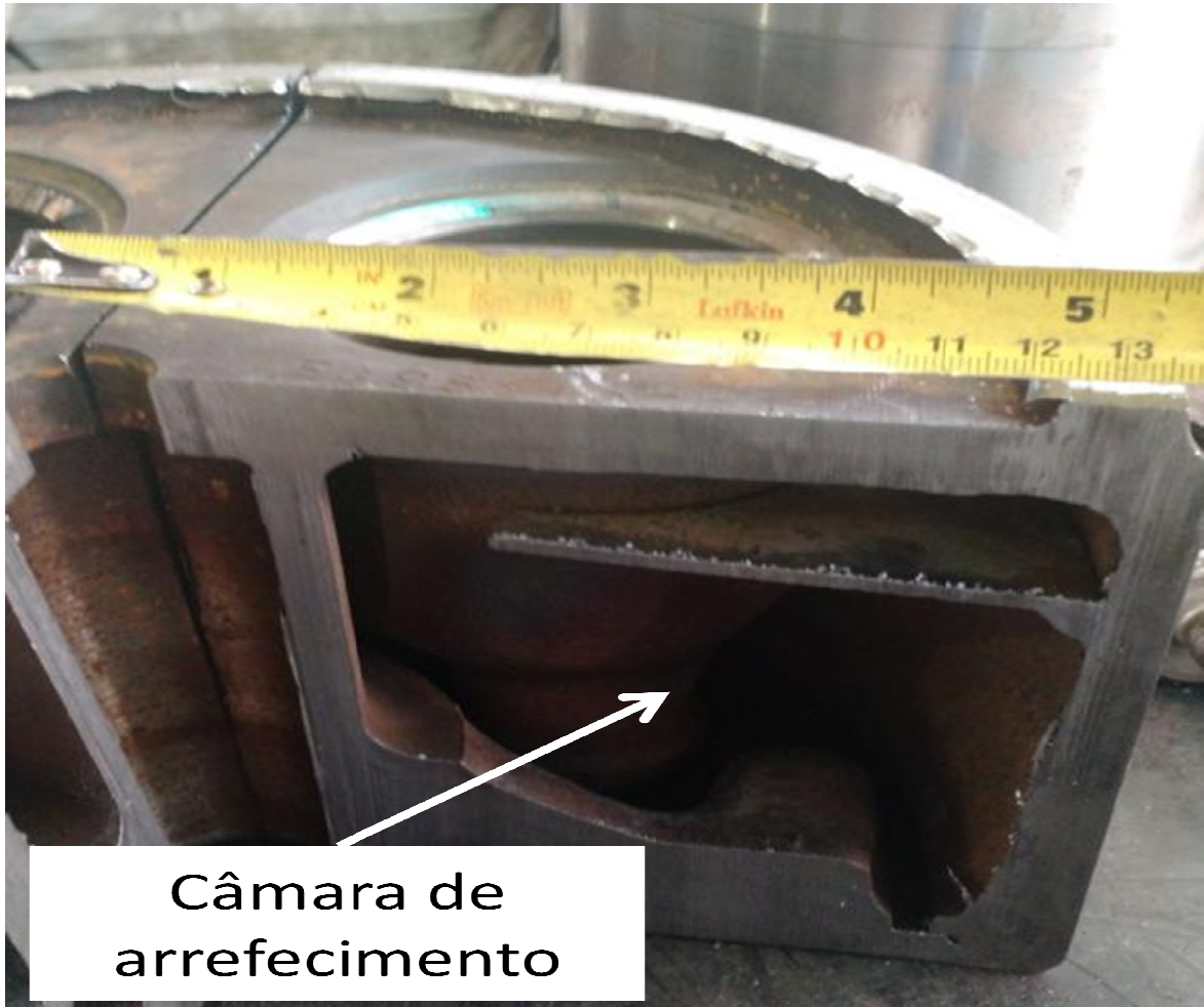
Figura 12 - Vista em corte do cabeçote do motor diesel 7FDL
