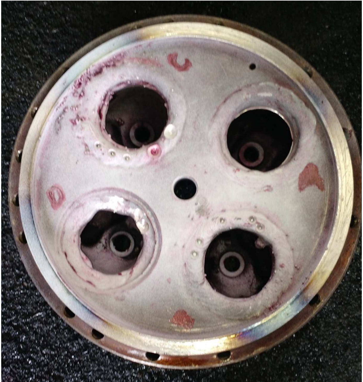
Figura 22 - Teste de líquido penetrante no cabeçote após enchimento com OK AutoRod 410NiMo ESAB (teste nº 1).
