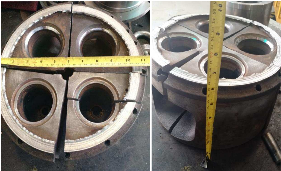
Figura 10 - Cabeçote de motor diesel 7FDL seccionado para análise
