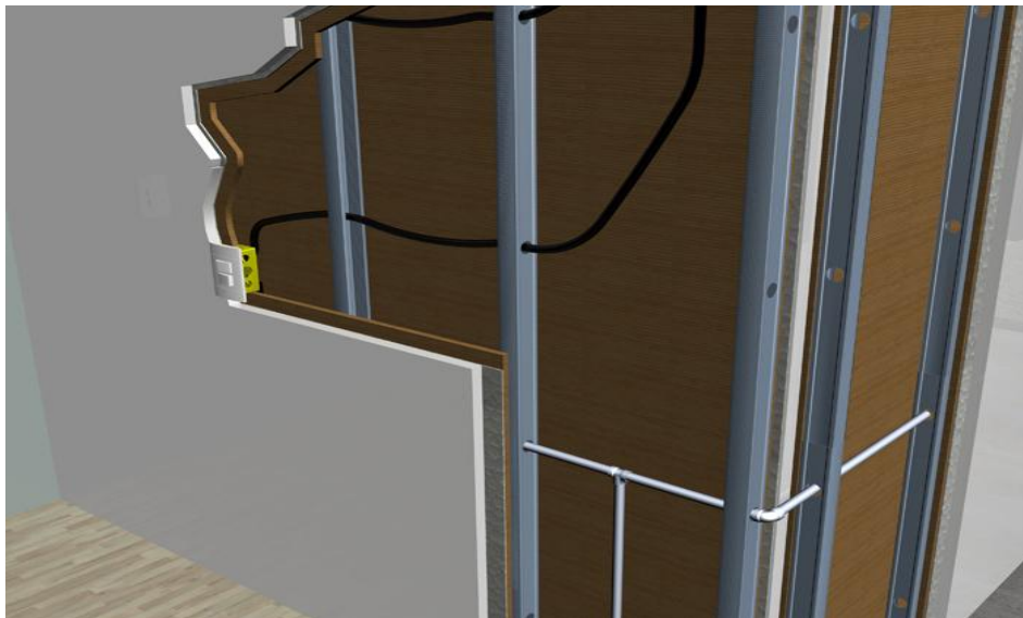
Figura 16: Passagem de instalação em paredes drywall
