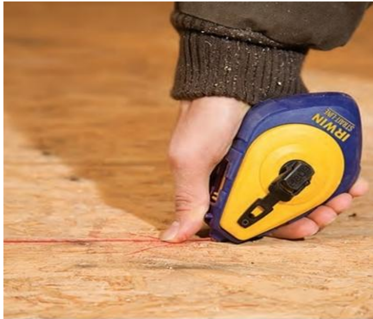
Figura 10: Cordão de marcação
