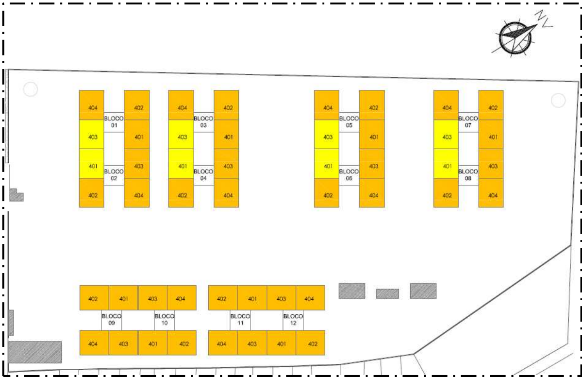
Figura 22– Níveis finais de eficiência das UH's do quarto pavimento
