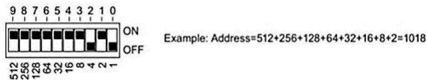
Figura 10: Configuração do Cartão F-DI/DO no " DIP-Switches ".
