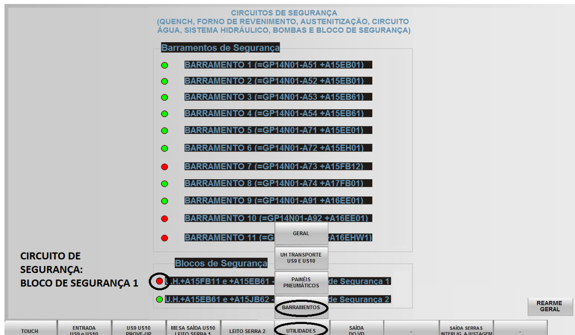
Figura 32: Circuito de segurança instalado no equipamento "Transporte da Têmpera".
