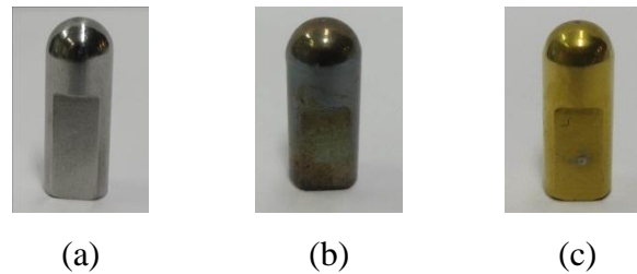
FIGURA 3. 2 - Pinos de topo esférico: a) pino sem revestimento; b) pino revestido com SiO 2 ; c) pino revestido com TiN
