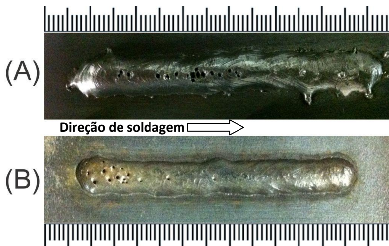
Figura 4.15 – Solda com porosidade – Fluxo C: stickout de 18 mm (A) e 12 mm (B).
