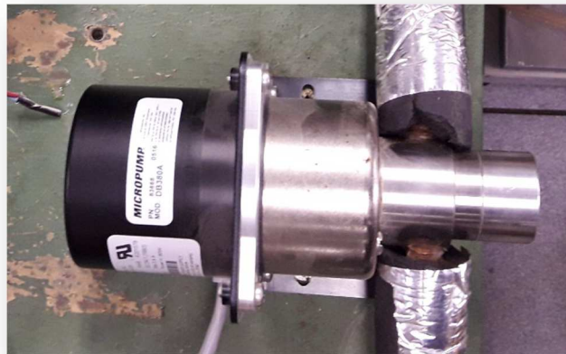
Figura 3.3 – Bomba de Engrenagens acoplada ao motor de passos
