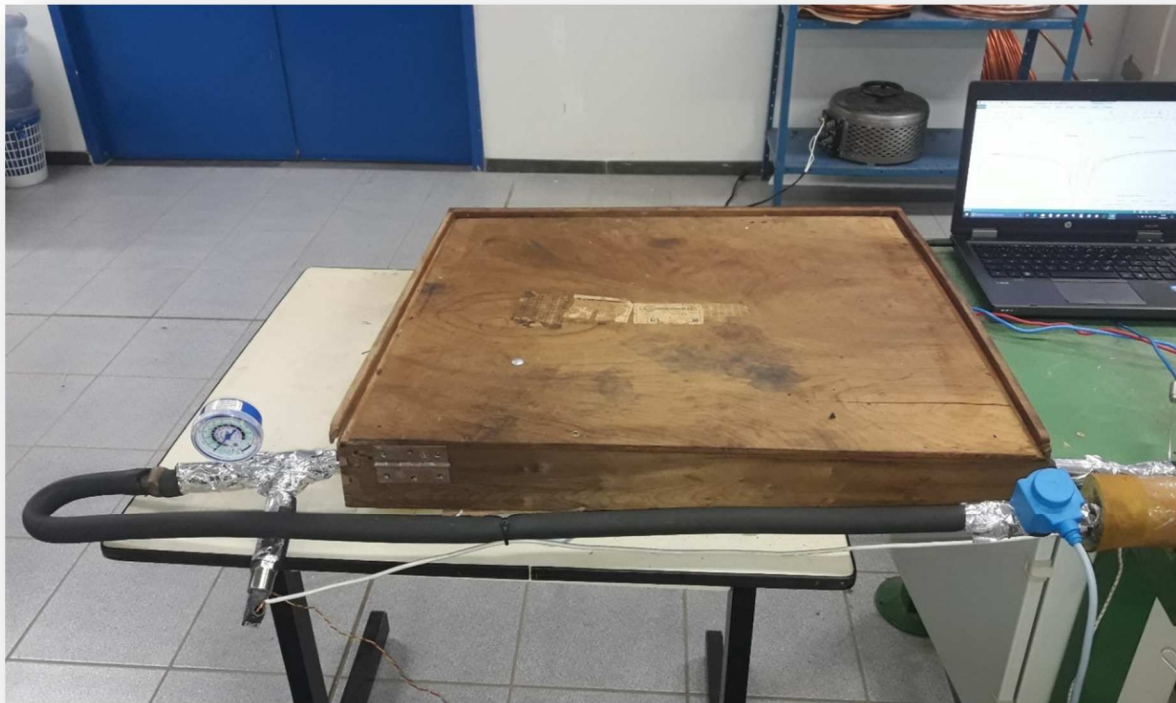
Figura 3.6 – Pré-aquecedor montado e instalado
