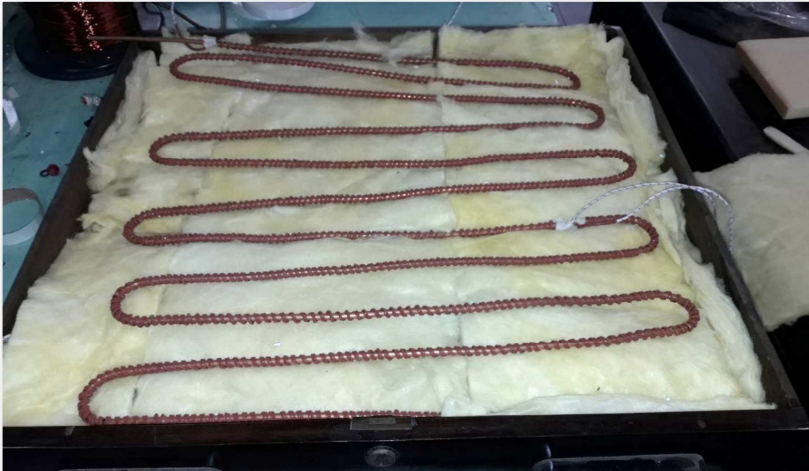
Figura 3.5 – Montagem do Pré-aquecedor
