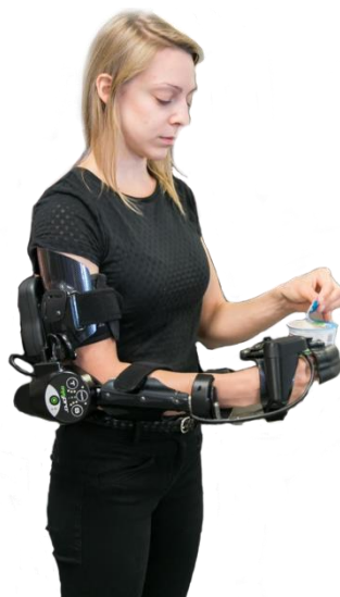
FIGURA 2.14 – Exoesqueleto Myomo e100 (Myomo. Inc., Boston, USA). FONTE - PAGE et al. , 2012
