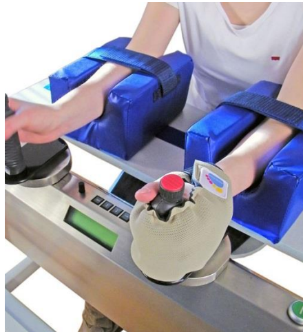
FIGURA 2.16 - Dispositivo robótico Bi-Manu-Track oferecendo exercício bimanual (Reha-Stim Co, Berlin, Alemanha). FONTE - HESSE et al. , 2005
