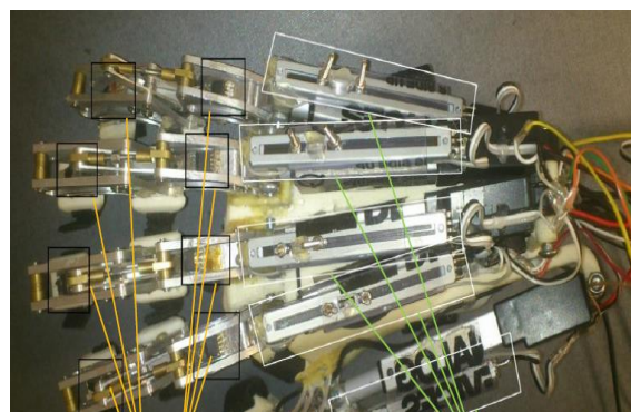
FIGURA 2.13 - Dispositivo robótico de mão. The modified hand exoskeleton robot. FONTE – SUSANTO et al. , 2015
