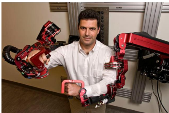
FIGURA 2.12 - Dispositivo robótico de membro superior completo. UL-EX07 exoskeleton. FONTE - BYL et al. , 2013
