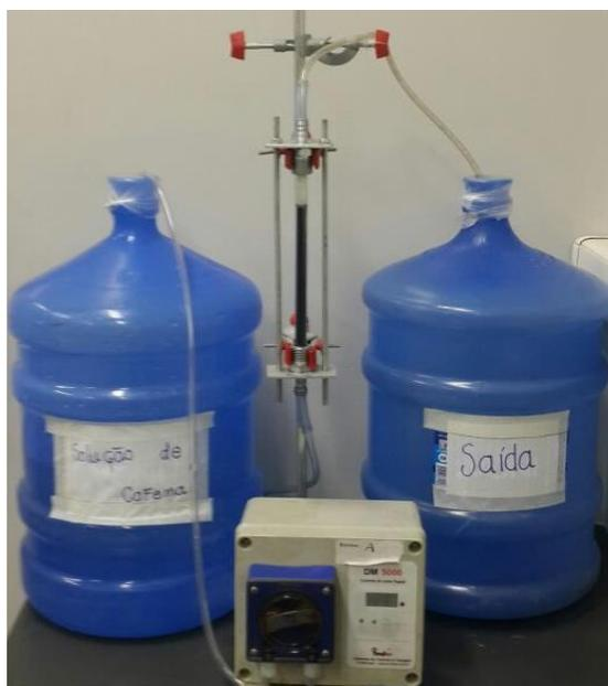
Figura 22. Unidade experimental para sistema de adsorção em leito fixo.
