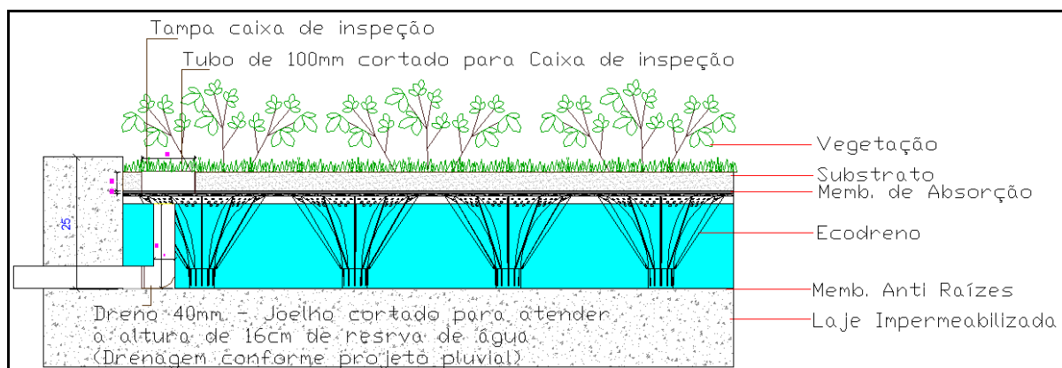
Figura 19 – Corte Representativo do Sistema Laminar Ecotelhado®
