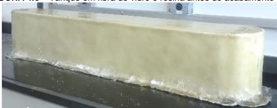
FIGURA 4.6 – Tanque em fibra de vidro e resina antes do acabamento final
