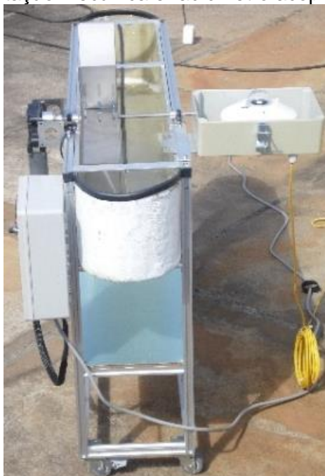
FIGURA 4.8 – Fotorreator do tipo RPR construído, com detalhes da parede central, pás de agitação mecânica e radiômetro acoplado
