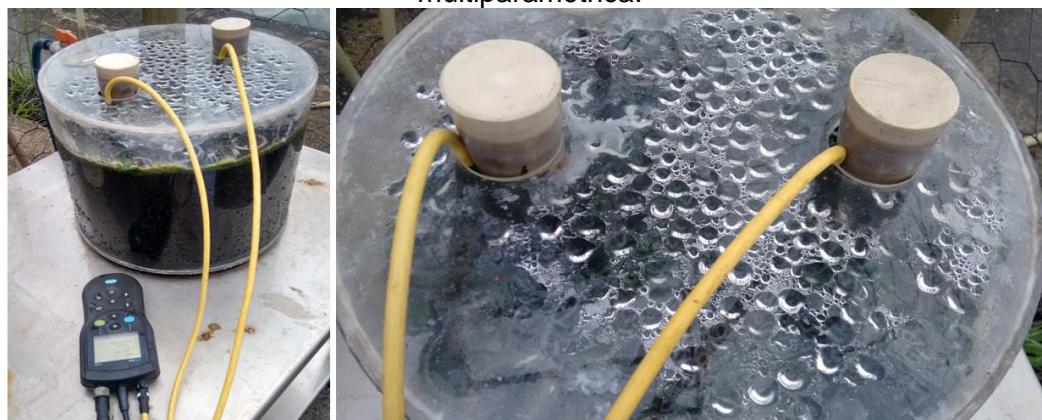
Figura 5.1 - Monitoramento realizado no interior dos reatores fototróficos a partir de sonda multiparamétrica.
