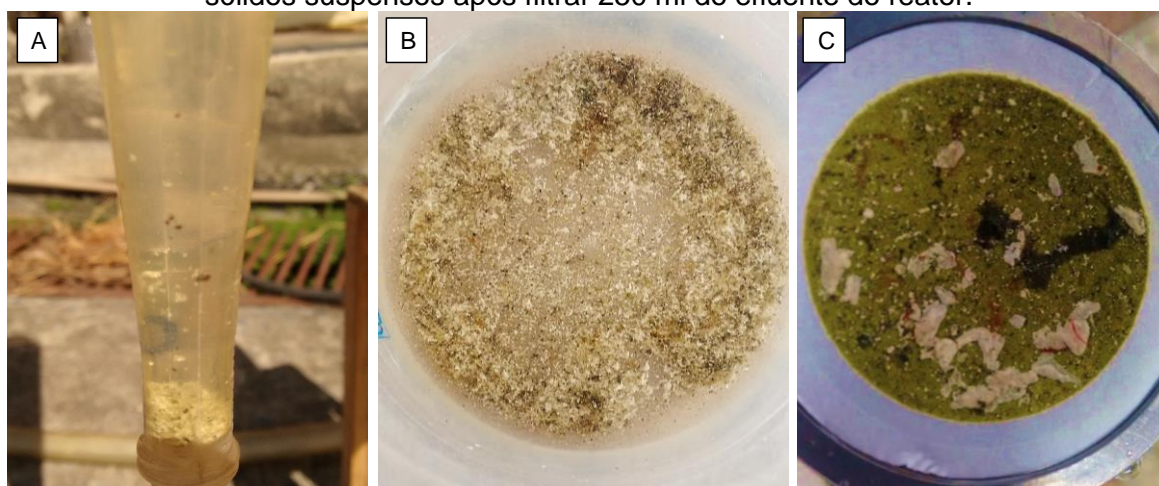
Figura 5.7 - Fotos do precipitado branco presente no efluente do R2-suporte durante a primeira fase do estudo (A) Ensaio de sedimentabilidade do efluente, após 30 minutos. (B) Imagem do precipitado presente no efluente do reator (C) Filtro utilizado para análise de sólidos suspensos após filtrar 250 ml do efluente do reator.
