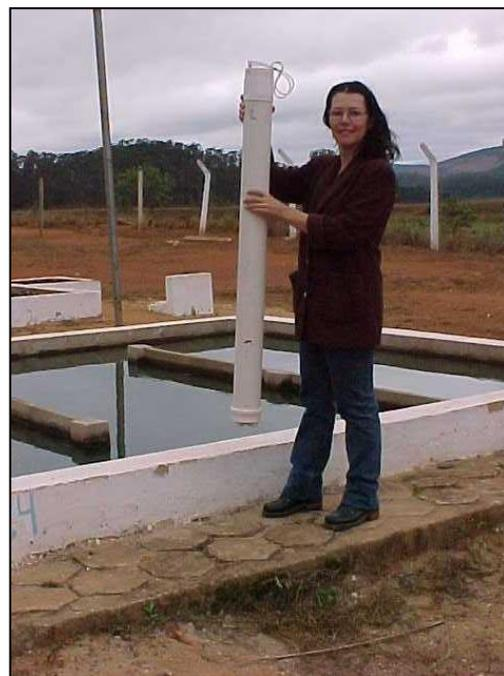
Figura -.4.19 Vista do amostrador em PVC 100 mm para coleta no perfil
