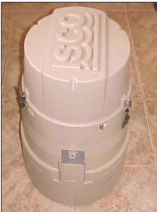
Figura -.4.18 Vista do amostrador automático
