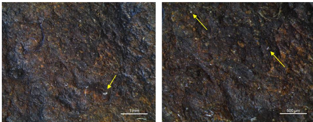
FIGURA 6.3 – Duas ampliações que mostram a incrustação de quartzo em uma pá do rotor de bomba centrífuga, proveniente do sedimento que foi bombeado
