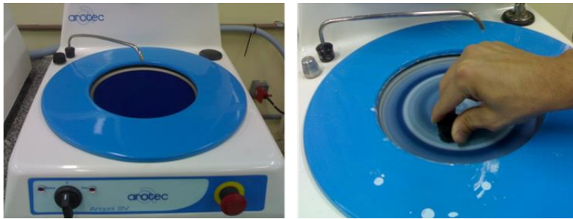
FIGURA 5.12 – Polimento das amostra em politriz de bancada
