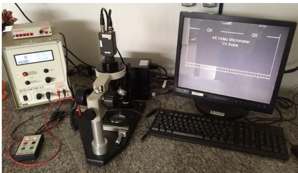
Figura 4. 6: Montagem para determinação do potencial zeta do quartzo no equipamento Zeta-Meter 4.0
