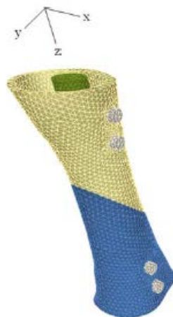
Fig. 5.6: Modelo de elementos finitos (68.202 elementos) da diáfise femoral de bezerro, apresentando fratura oblíqua simples (40°, A2 – AO/ASIF), bloqueio por quatro parafusos de aço.
