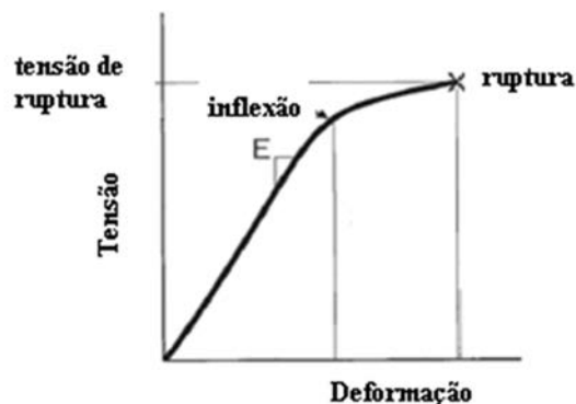
Fig. 3.6: Curva tensão-deformação para o osso (tração).
