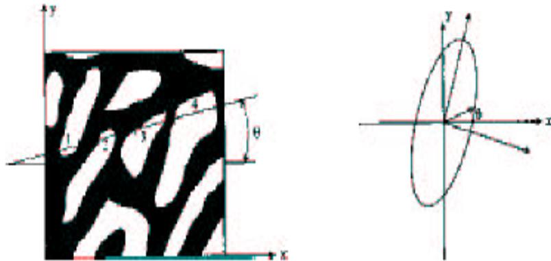
Fig. 2.16: Cálculo tensor textura. Esquerda: exemplo para determinação da distância média entre duas interfaces osso-medula. Direita: distância média como função do ângulo. Fonte: Rüberg (2003).
