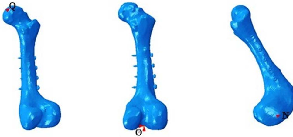
Fig. 6.23: Restrições aplicadas ao fêmur adaptado de Bayoglu e Okyar (2015).
