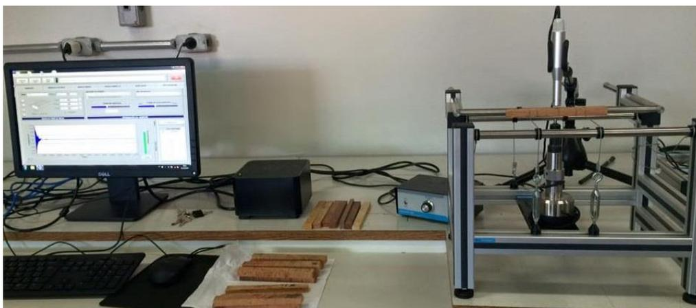
**Figura 3.3-** Ensaio utilizando o método de propagação de ondas de excitação.
