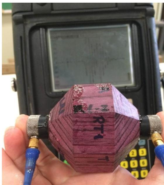
**Figura 3.5** – Corpo de prova utilizado no ensaio de propagação de ondas ultrassônicas.
