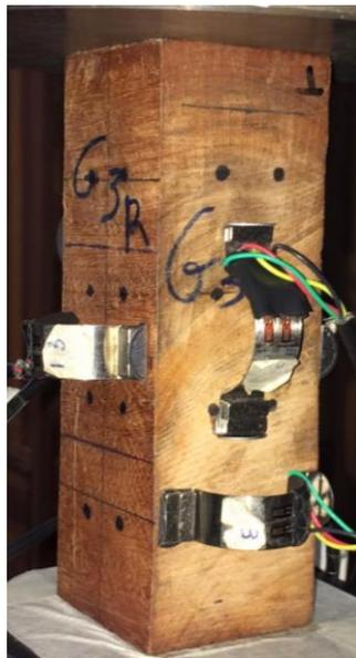
**Figura 2.1-** Esquema de instalação do MD no CP de compressão.
