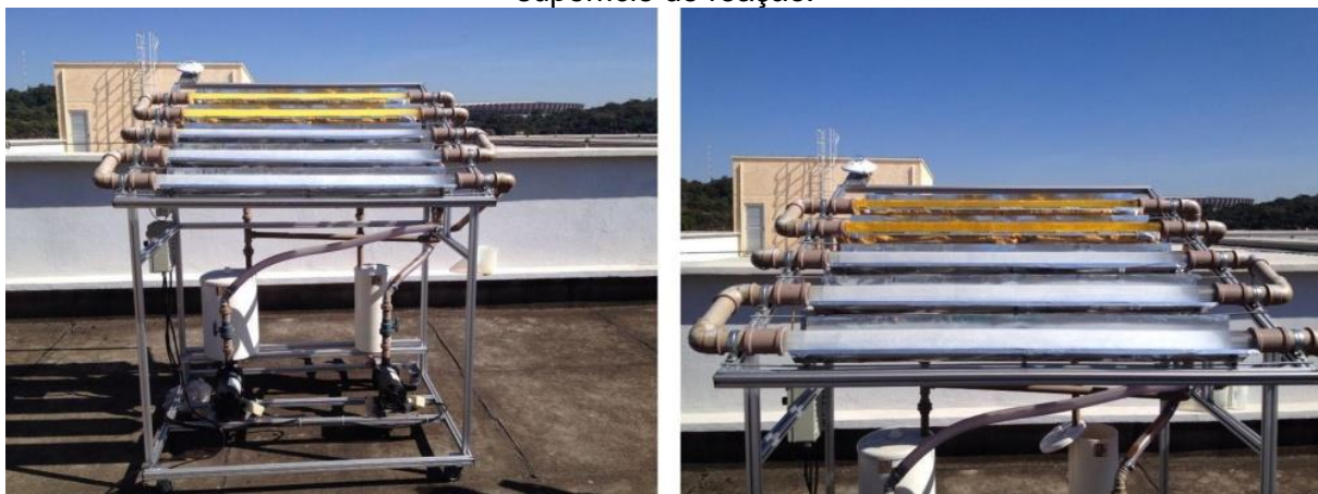
Figura 6.3- Instalação do reator solar CPC. À esquerda vista geral, à direita enfoque na superfície de reação.
