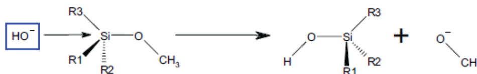
Figura 3.24. Hidrólise catalisada por álcali [MATERNE et al. , 2012].
