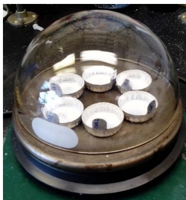
Figura 22: Preparo dos filmes via casting utilizando formas de alumínio sobre uma placa com aquecimento controlado cobertas com uma doma de vidro.
