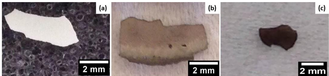
Figura 50: Fotografia do filme puro (a), após a deposição do níquel (b) e após a remoção do copolímero (c).
