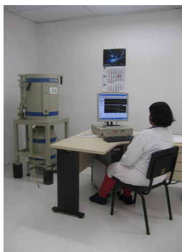
Figura 12. Sistema de espectrometria gama.
