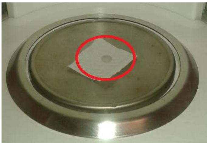
Figura 7. Monitor de fluxo de nêutrons Al-(0,1%)Au, em destaque.
