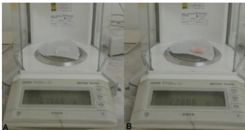
Figura 6. Aferição das massas: A) Tubo de polietileno. B) Tubo de polietileno juntamente com o suplemento alimentar.
