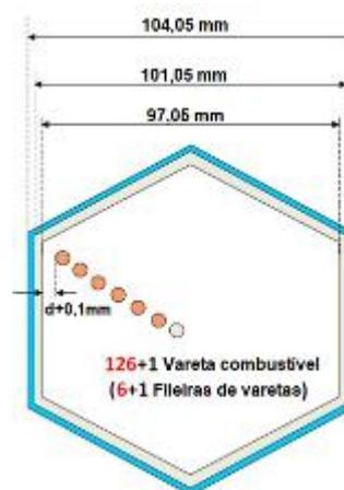
**Figura 3-4:** Modelo de um elemento combustível proposto para ser simulado
