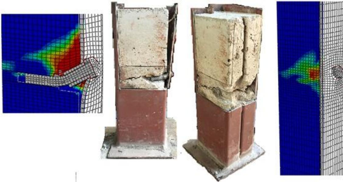
Figura 4-46 – Dano à compressão do concreto no último incremento 104.
