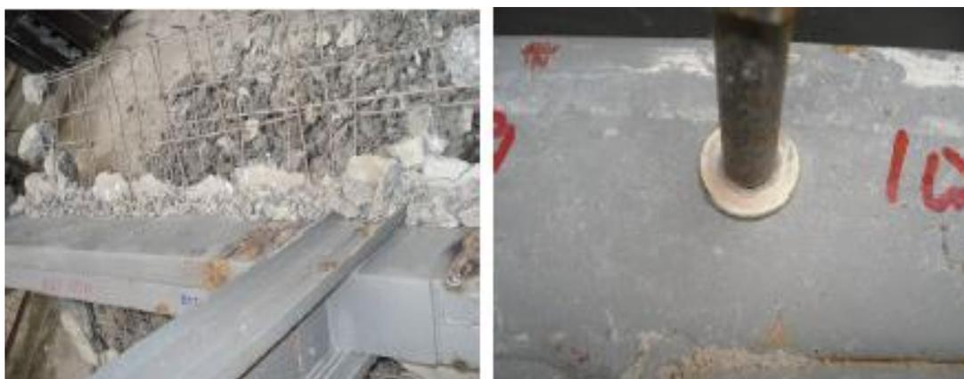
Figura 2-11 – Conectores de cisalhamento depois do ensaio, após remoção da laje de concreto do modelo (Quiñorez, 2007).
