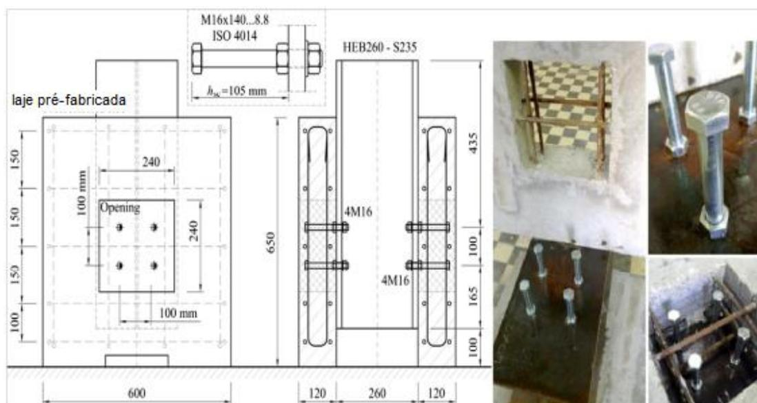
Figura 2-19 – Preparação e montagem dos ensaios (Pavlovic *et al.*, 2013).
