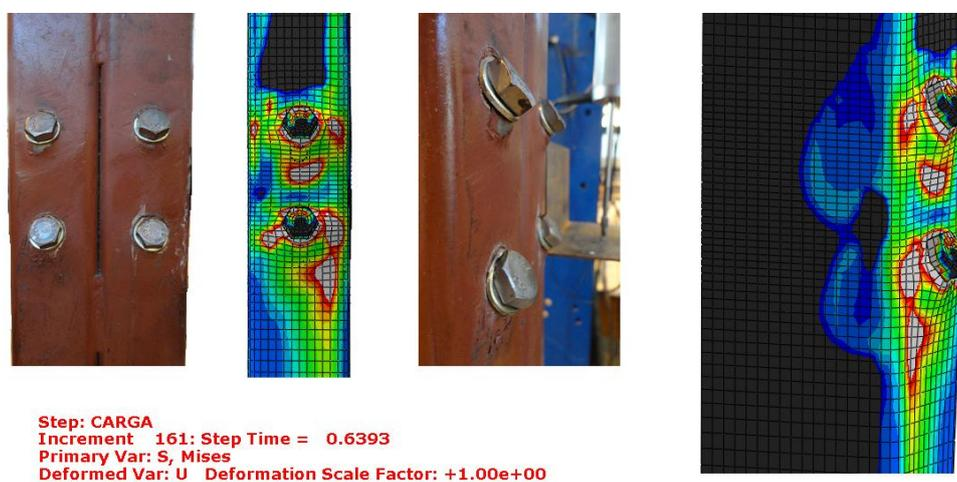
Figura 4-60 – escoamento do aço do perfil no último incremento 161.
