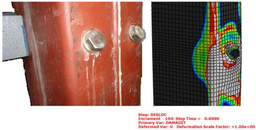
Figura 4-50 – escoamento do aço do perfil no último incremento 104.
