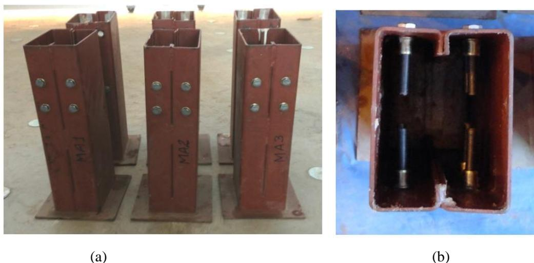
Figura 3-1 – Modelos da série B8 em primeiro plano e da série B4 em segundo plano, antes de serem concretados: (a) vista externa dos modelos B4 e B8; (b) vista interna do modelo B4-1 (Cardoso *et al.*, 2014).
