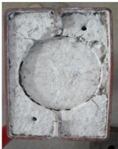
Figura 3-7 – Vista superior do modelo B8-1 após a realização do ensaio (Cardoso *et al.*, 2014).
