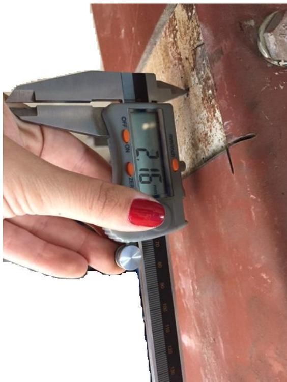
Figura 4-24 – Abertura da fissura medida por um paquímetro (LAEES) – Modelo B8-3.
