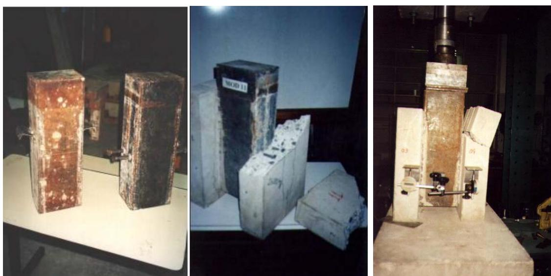
Figura 2-6 – (a) Configurações dos conectores após ensaio (b) Ruptura no modelo: Concreto sem armadura e conector rebite com rosca interna (c) Concreto com armadura e conector rebite com rosca interna (Oliveira, 2001).
