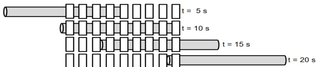
Figura 5.13 Desenho esquemático da posição do tubo nos anéis de tempera para os instantes 5s, 10s, 15s e 20s
