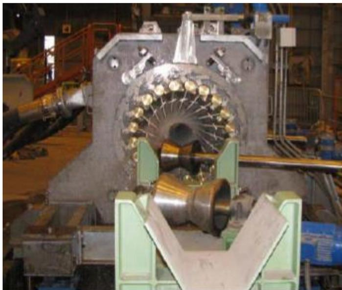
Figura 5.5 Rolos transportadores e anel de resfriamento.
