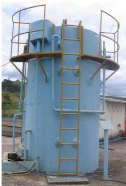
**Figura 4.3** Reator UASB, em escala de demonstração, utilizado no presente estudo
