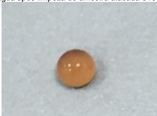
Figura 32 – Gota de água após limpeza de amostra atacada e revestida com ORMOSIL
