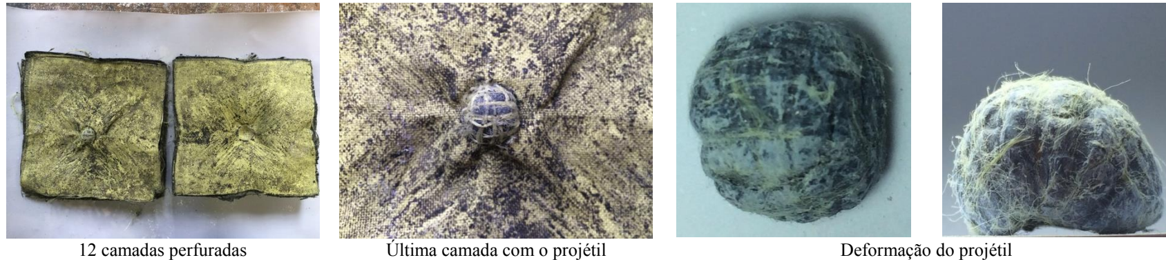
FIGURA 112 - Camadas perfuradas e deformação do projétil em placa de 32 camadas tratadas com STF7 (100% NS) após os ensaios balísticos com projéteis .357 Magnum FSP .
