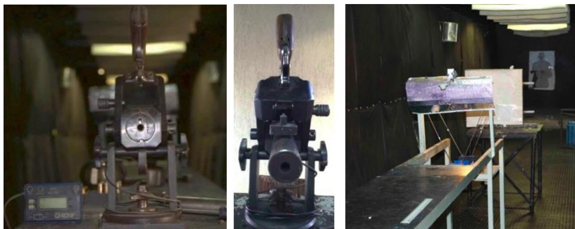
FIGURA 29 - Linha de teste utilizada para ensaios balísticos.
