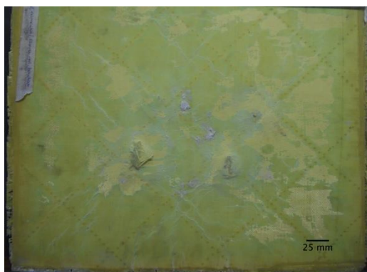
FIGURA 48 - Parte traseira da placa P4, com sistema epóxi apenas nas bordas, sem nenhuma perfuração após os testes balísticos.
