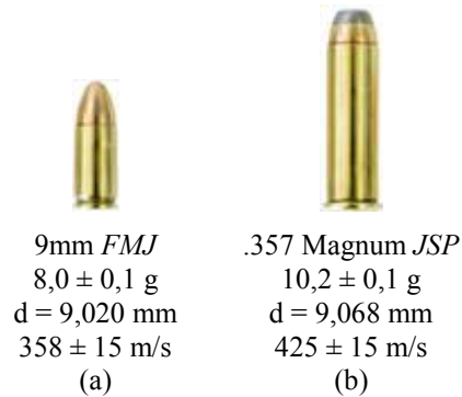
FIGURA 37 - Projéteis de classificação NIJ tipo II utilizados nos ensaios: (a) 9mm FMJ e (b) .357 Magnum JSP . Adaptado de BCA (2013).
