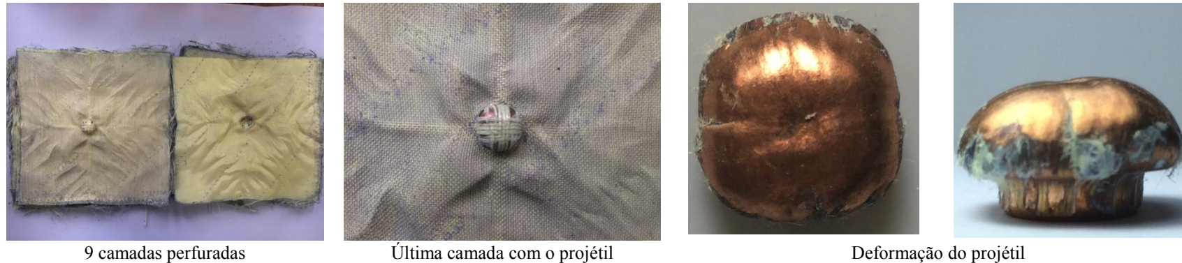
FIGURA 82 - Camadas perfuradas e deformação do projétil em placa de 18 camadas tratadas com STF5 (50% \text{CaCO}_3 + 50% NS) após os ensaios balísticos com projéteis de 9mm FMJ .
