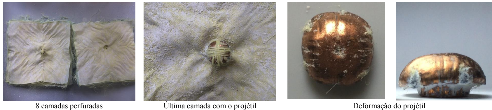
FIGURA 80 - Camadas perfuradas e deformação do projétil em placa de 18 camadas tratadas com STF3 (100%CaCO 3 ) após os ensaios balísticos com projéteis de 9mm FMJ .
