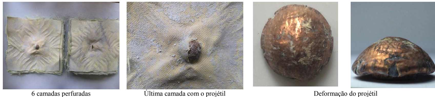
FIGURA 83 - Camadas perfuradas e deformação do projétil em placa de 18 camadas tratadas com STF6 (25% \text{CaCO}_3 + 75% NS) após os ensaios balísticos com projéteis de 9mm FMJ .
