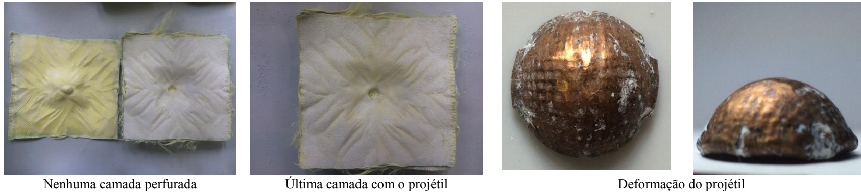
FIGURA 81 - Camadas perfuradas e deformação do projétil em placa de 18 camadas tratadas com STF4 (75% \text{CaCO}_3 + 25% NS) após os ensaios balísticos com projéteis de 9mm FMJ .
