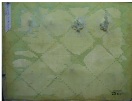
FIGURA 49 - Parte traseira da placa P5, totalmente rígida pelo sistema epóxi, com duas perfurações de projéteis .357 Magnum FSP , cujas velocidades excederam a velocidade máxima prevista na norma NIJ.
