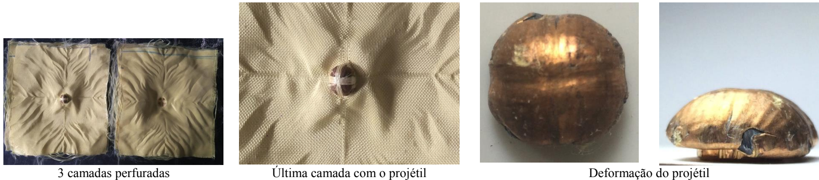
FIGURA 79 - Camadas perfuradas e deformação do projétil em placa de 18 camadas sem tratamento após os ensaios balísticos com projéteis de 9mm FMJ .
