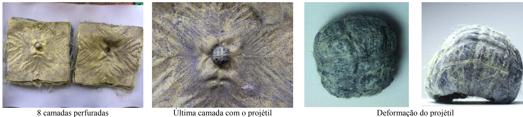
FIGURA 98 - Camadas perfuradas e deformação do projétil em placa de 24 camadas tratadas com STF5 (50% CaCO 3 + 50% NS) após os ensaios balísticos com projéteis .357 Magnum FSP.
