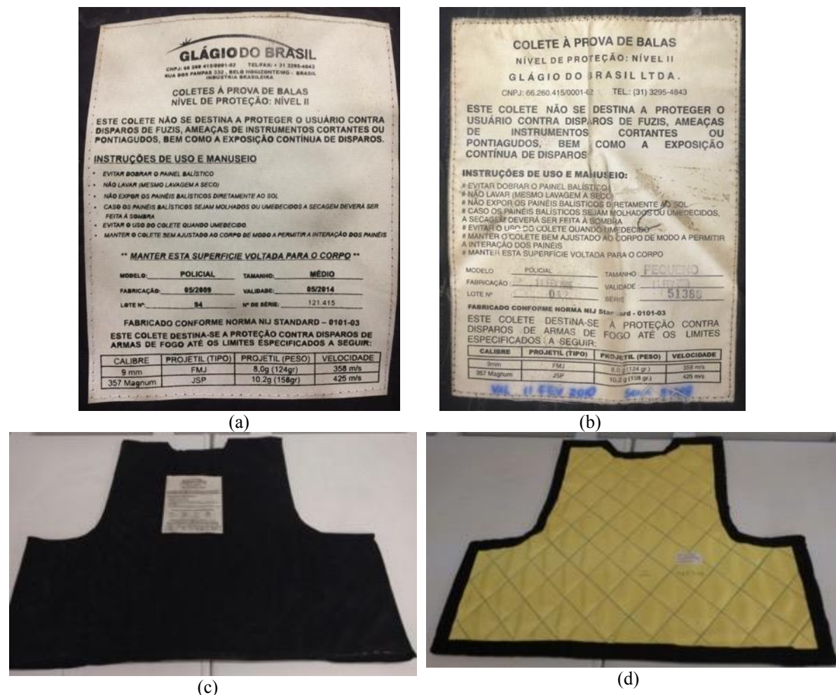
FIGURA 28 - Coletes balísticos vencidos fornecidos pela PMMG sendo (a) etiqueta de identificação de coletes vencidos em 2014 e utilizados na primeira fase, (b) etiqueta de identificação de coletes vencidos em 2010 e utilizados na fase preliminar e na segunda fase, (c) parte traseira do colete e (d) preenchimento interno de fibras de aramida costuradas e sem a proteção plástica.
