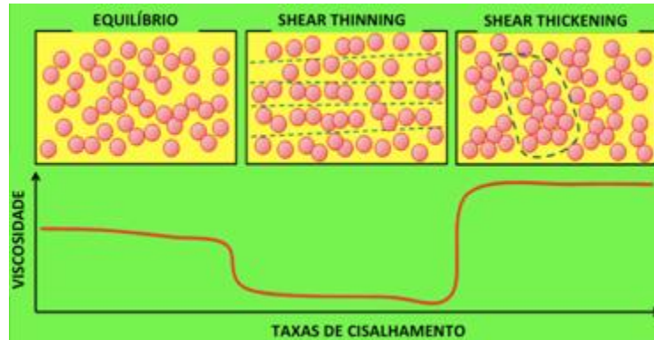
FIGURA 23 - Variações na viscosidade de fluidos não Newtonianos em função da taxa de cisalhamento. Adaptado de DING et al. (2013).
