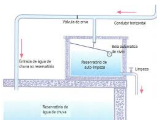
Figura 3.5: Reservatório de auto limpeza
