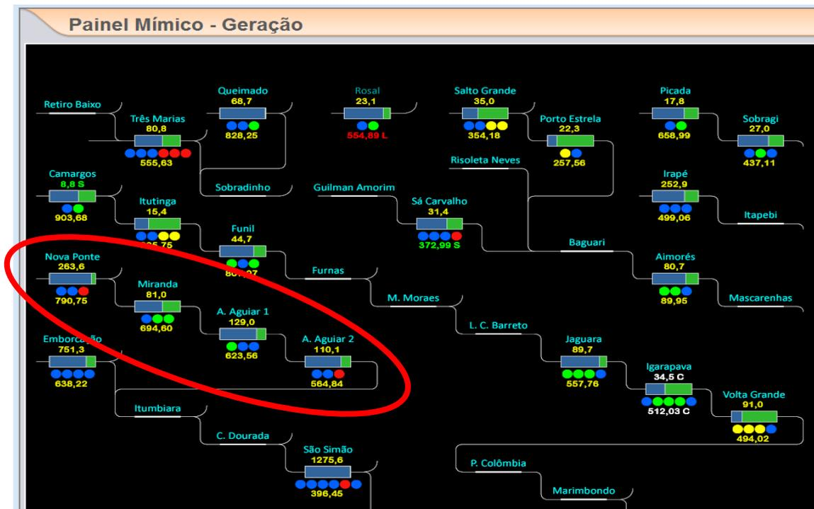
FIGURA 13 – Imagem do painel mímico de geração e, em destaque, a cascata da usina de Miranda.
