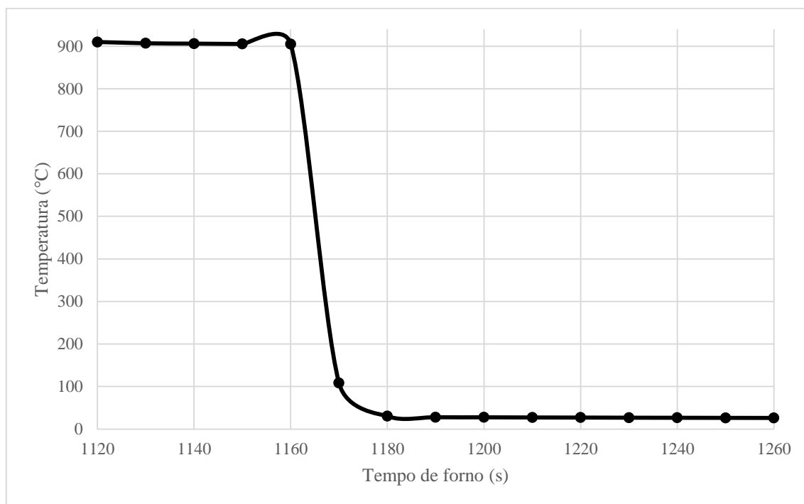
Figura 9.3 – Perfil térmico: austenitização a 910°C 10 min e têmpera em água, detalhe do monitoramento durante realização da têmpera em água.
