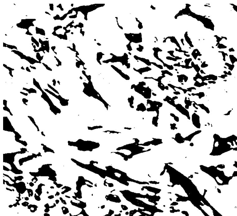
Figura 102 – Imagem monocromática dos carbonetos M_7C_3 obtida após Thershold
