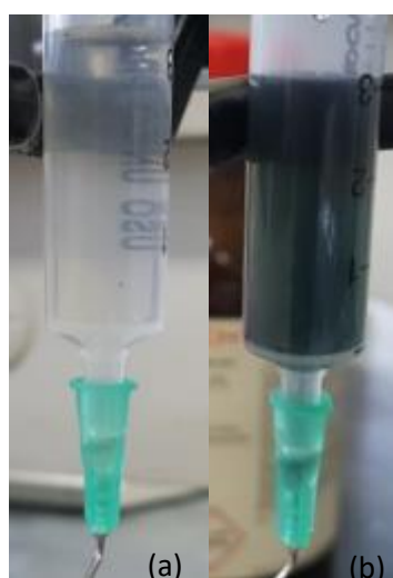
Figura 4.17 Modificação da coloração da solução na seringa do eletrofiador.(a) Solução após ser colocada e (b) após 1 hora.
