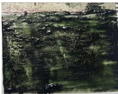
Figura 4.9 Exemplo de formação do gel com PANI incorporada sobre o substrato de PET-TCO
