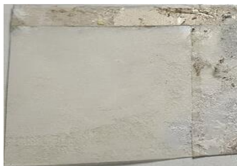
Figura 4.8 Substrato de PET-TCO com filme formado de \text{TiO}_2
