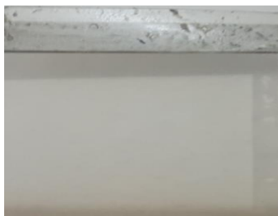
Figura 4.7 Substrato de PET recoberto com óxido de estanho dopado com índio (ITO) com um contato de alumínio depositado na borda superior.
