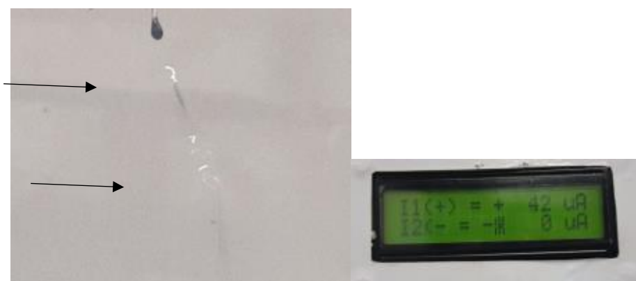
Figura 5.51 Imagem das nanofibras formando arcos elétricos (esquerda) e o medidor de corrente do eletrofiador.
