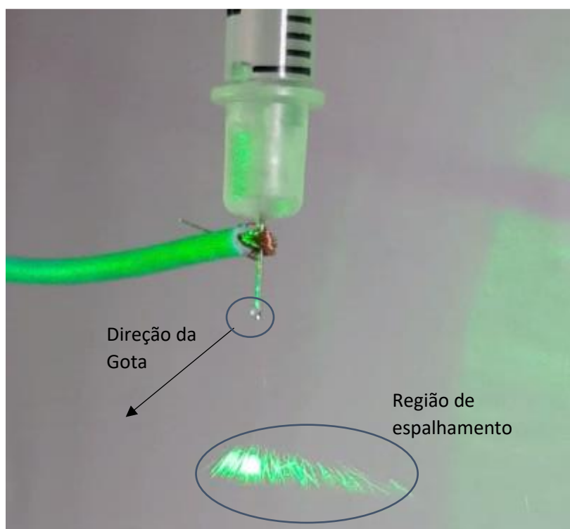
Figura 5.38 Foto da agulha do Eletrofiador mostrando o reflexo do laser verde de comprimento de onda 532nm e potência de 200mW na nanofibras em formação.
