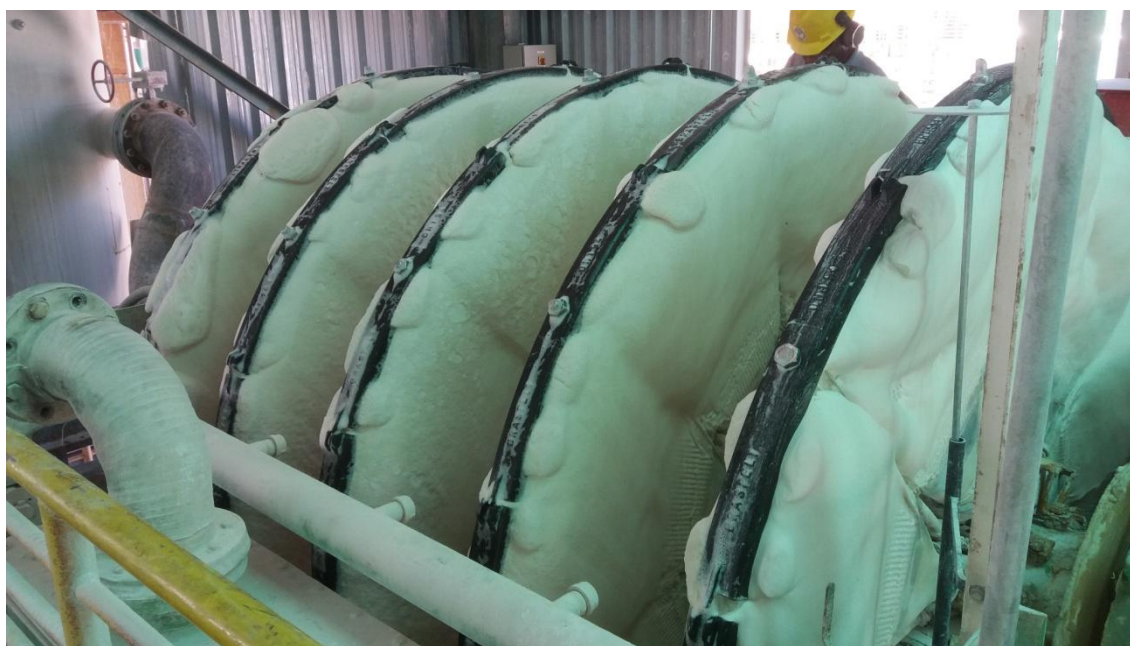
Figura 5.27 – Filtragem de concentrado de magnesita.
