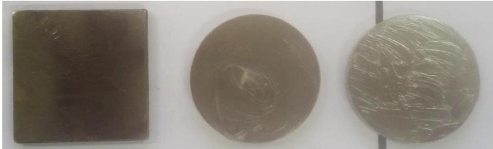
Figura 4.9 – Amostras utilizadas nos ensaios de abrasão (A-36, AISI 316 e AISI 304 respectivamente).
