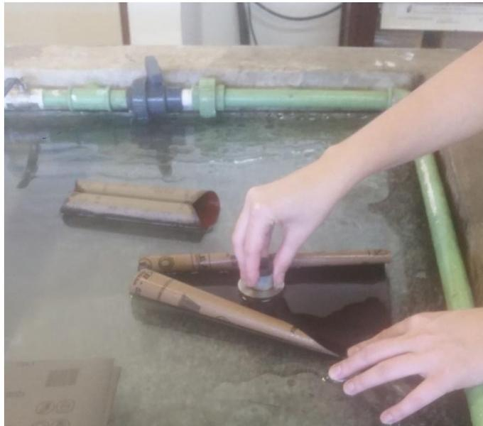
Figura 4.10 – Lixamento pelo processo úmido das amostras a serem utilizadas nos ensaios de abrasão.
