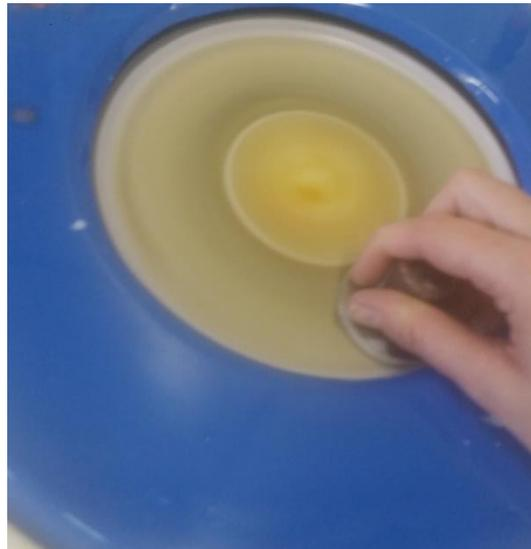
Figura 4.12 –Polimento das placas a serem utilizadas nos ensaios de abrasão
