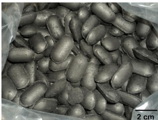
Figura 3.14: Briquetes preparados a partir de resíduos de MgO-C e finos de dolomita (LUZ, VIVALDINI, *et al.*, 2013).
