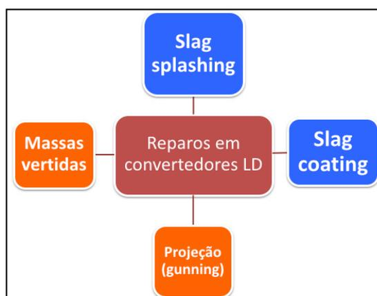
Figura 3.2: Diagrama de técnica de reparos (AUAD, 2011).
