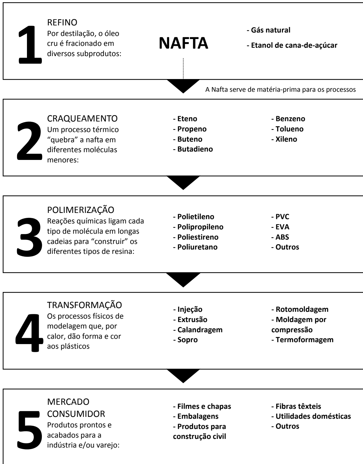
FIGURA 2.5 – Processamento para a obtenção de plásticos.
