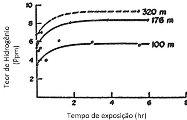
FIGURA 2.13 - Teor de hidrogênio na atmosfera do arco elétrico em um eletrodo exposto ao ambiente úmido.
