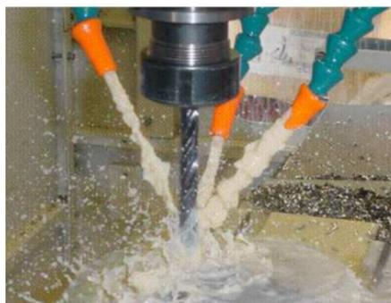
FIGURA 18 - Exemplo de aplicação de fluido de corte geral, à baixa pressão
