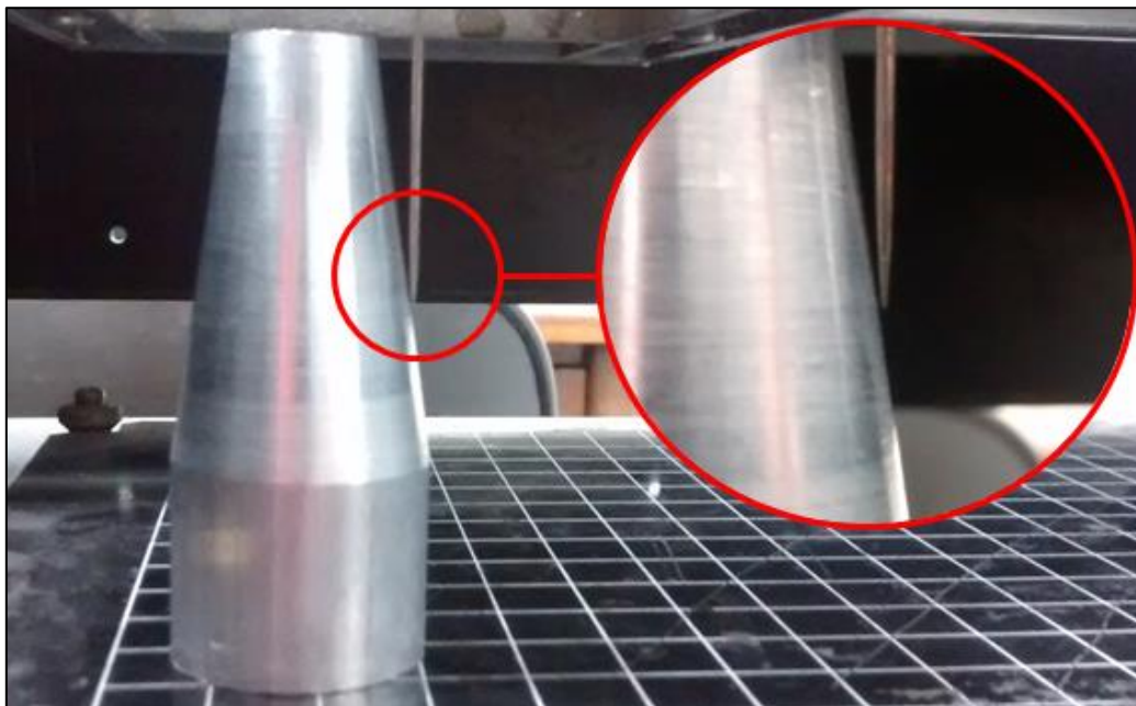
Figura 35: Processo de aquisição de pontos por contato.
