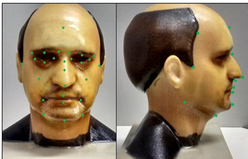
Figura 55: Marcos faciais utilizados para geração do modelo virtual do busto.
