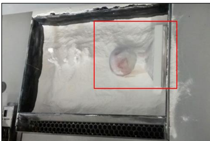
Figura 51: Impressão do modelo físico imerso em sulfato de cálcio
