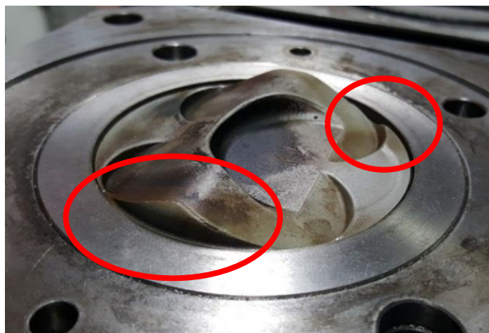
Figura 21 – Pistão no PMS para análise de regiões acima e abaixo do bloco
