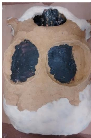
Figura 3-7: Detalhe do tecido substituto adiposo no arcabouço tóraco do simulador
