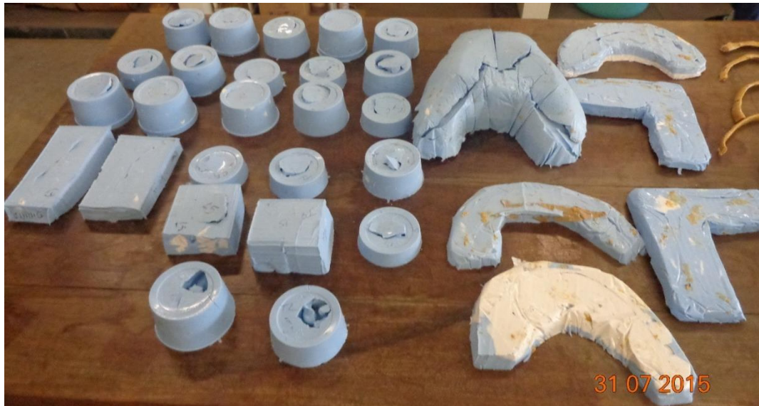
Figura 3-1: Moldes de silicone confeccionados para cada estrutura osséa
