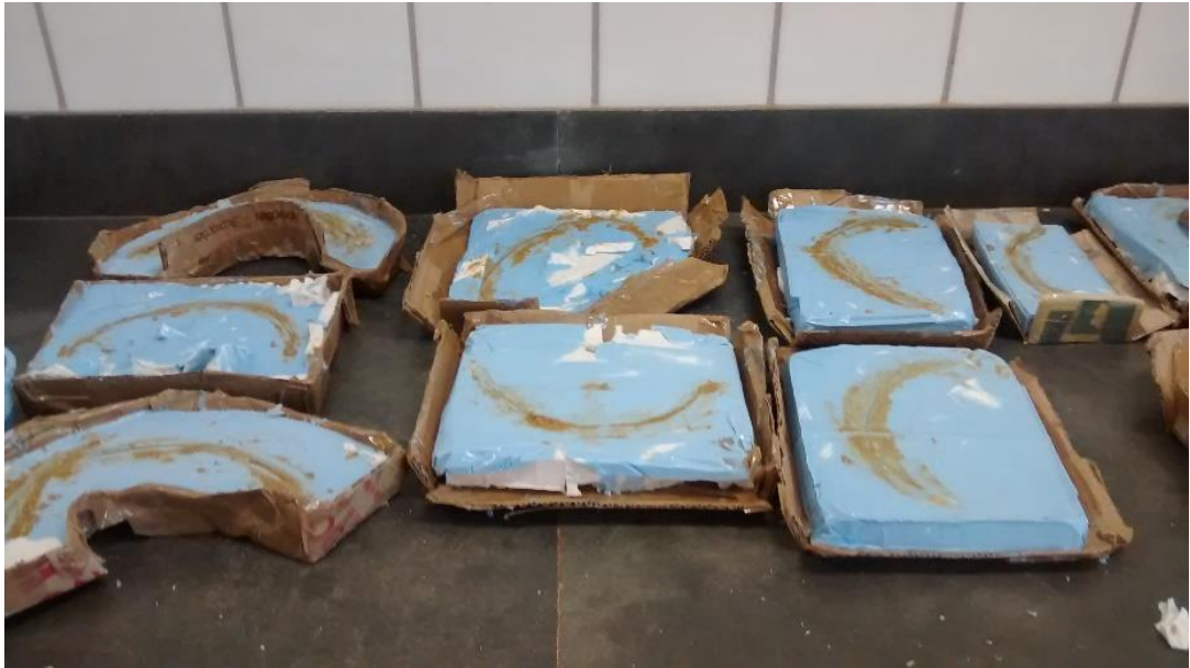
Figura 3-3: Tecido substituto ósseo nas formas de silicone
