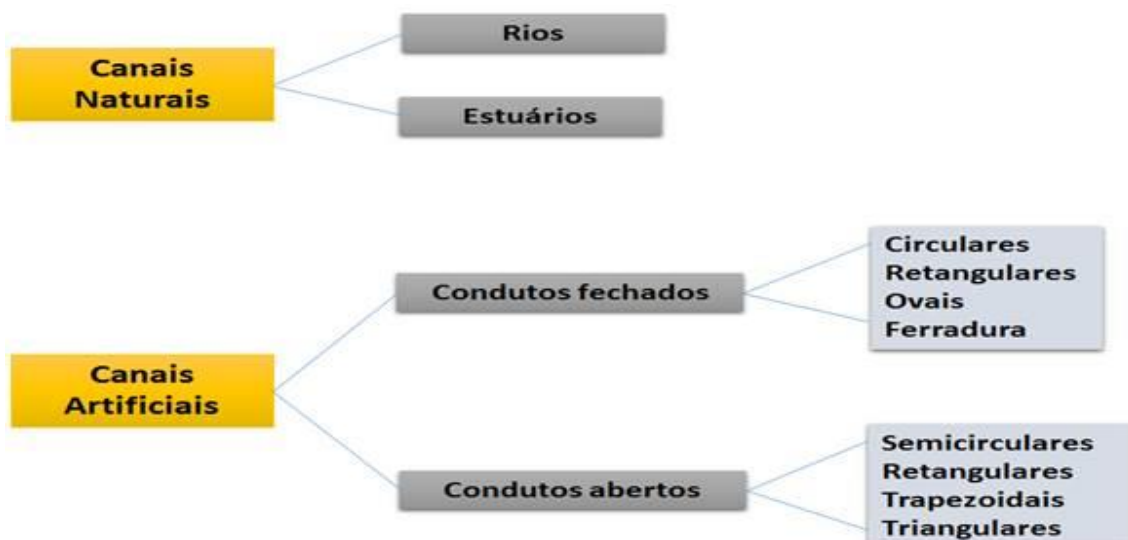
FIGURA 4.7 – Classificação canais naturais e artificiais FONTE – ADAPTADO DE BONILHA, 1991
