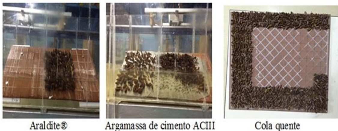
FIGURA 5.10 – Aglutinantes utilizados para testes iniciais de infestação artificial de L. fortunei
