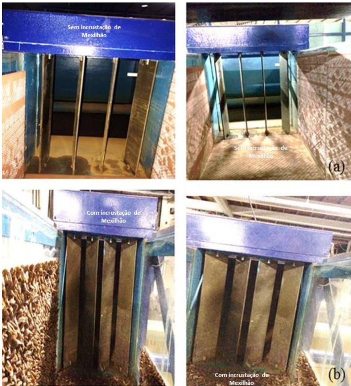
FIGURA 5.4 – Localização das comportas tipo cortina Comporta a montante, (b) Comporta a jusante
